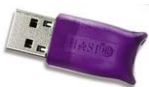
Электронный ключ поставляется вместе с ПАК и обеспечивает его функционирование. Брелок подключается в USB порт на компьютер, на котором установлен HAS сервер. Необходимое программное обеспечение для работы HASP ключа будет загружено на компьютер в процессе установки ПАК МОСКит.
